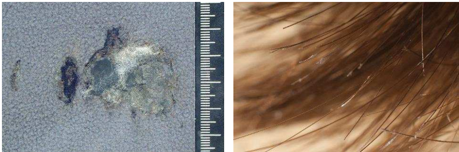
9–10. számú fényképek Termikus elváltozás textílián (bal) és hajszálakon (jobb)
