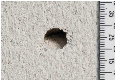
20–21. számú fényképek Bemeneti nyílás (bal) és kimeneti nyílás(jobb) Ytong téglán
