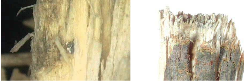
13–14. számú fényképek Lövedékből származó fémszemcse (bal) és fémfelkenődés (jobb)
