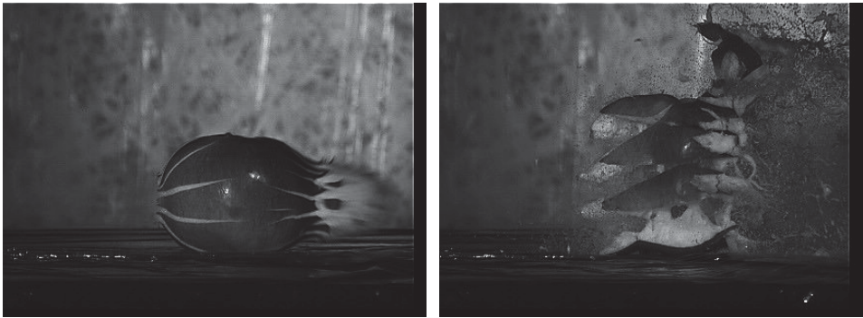
4–5. számú fényképek A lökeshullám keltette nyomás hatása
