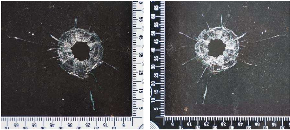
22–23. számú fényképek Bemeneti nyílás (bal) és kimeneti nyílás (jobb) ablaküvegen
