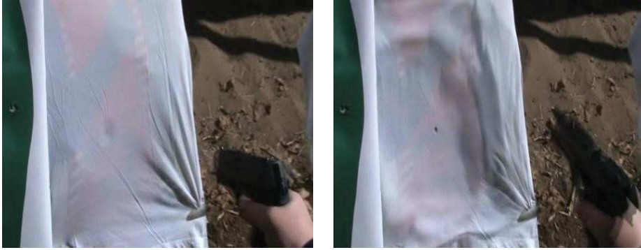
6–7. számú fényképek A lökéshullám hatásának bemutatása textílián
