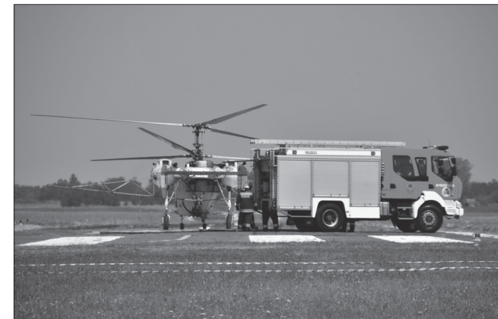
3. kép: Ka-26-os helikopter feltöltése gépjárműfecskendőből a nyíregyházi repülőtéren
