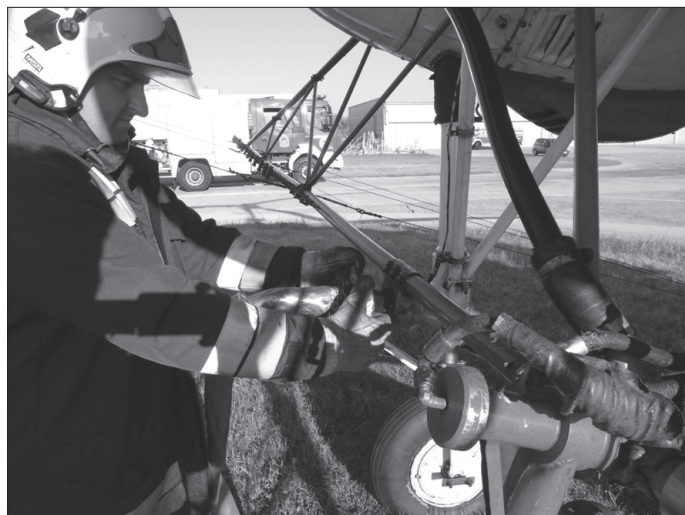
5. kép. A Ka-26-os helikopter feltöltése a gépjárműfecskendőn keresztül
