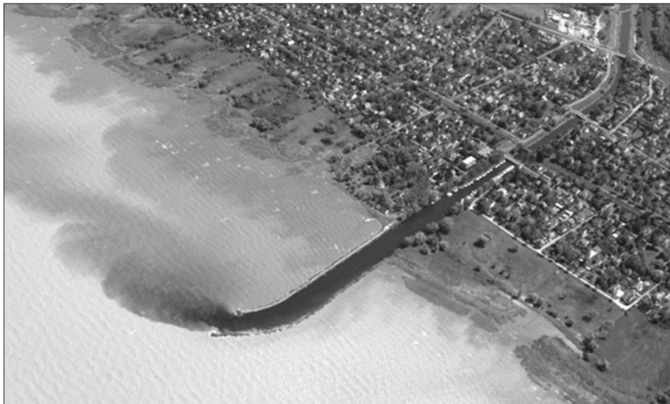
1. ábra: Balatonba érkező, hordalékban szegényebb vízfolyás vizének elkeveredése és elszállítódása
